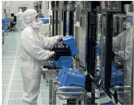
La fabbricazione e l'assemblaggio dei dispositivi elettronici avviene nelle cosiddette *clean room*, ambienti a bassissimo contenuto di micro particelle di polvere in sospensione, centinaia di volte più puliti di una sala operatoria!
